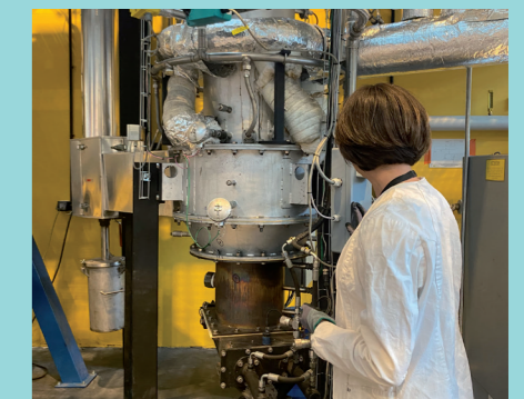
Pilote de pyrogazéification
